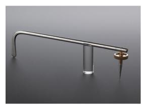
На основе принципа движения велосипеда можно самостоятельно довольно просто сделать прибор для измерения площади, так называемый планиметр.
