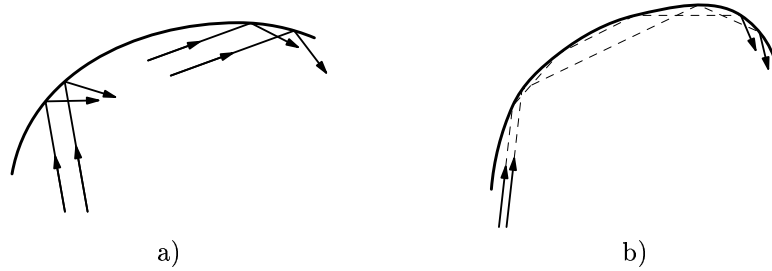
Рис. 6. а) фокусирующее зеркало, б) абсолютно фокусирующее зеркало
